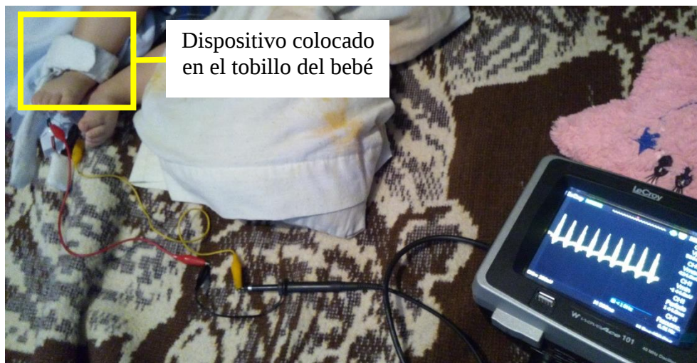
Figura 5.16: Osciloscopio conectado a la salida del sensor de pulso del dispositivo.
