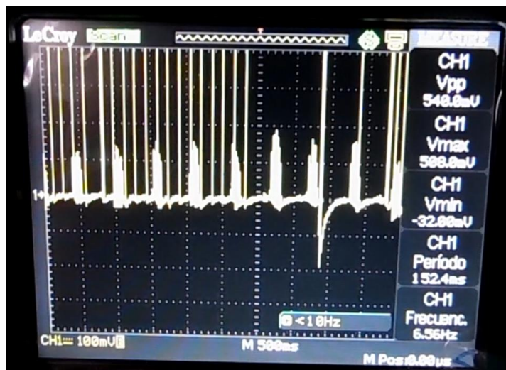
Figura 5.7: Señal de salida del sensor de pulso afectada por el ruido del módulo Wi-Fi.
