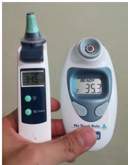
Figura 5.30: Temperatura obtenida del tobillo con los termómetros comerciales.
