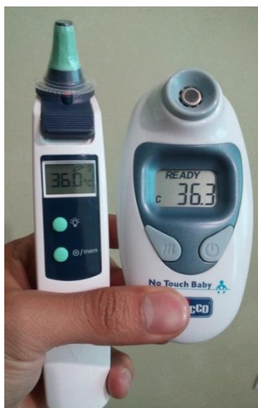
Figura 5.28: Temperatura obtenida de la palma de la mano con los termómetros comerciales.
