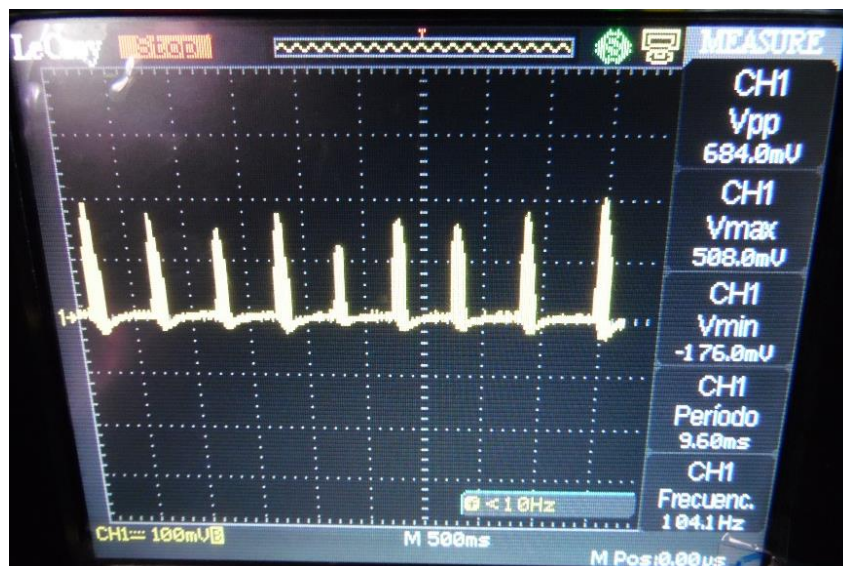
Figura 5.46: Respuesta del ritmo cardíaco en el tobillo del bebé, visto en el osciloscopio.
