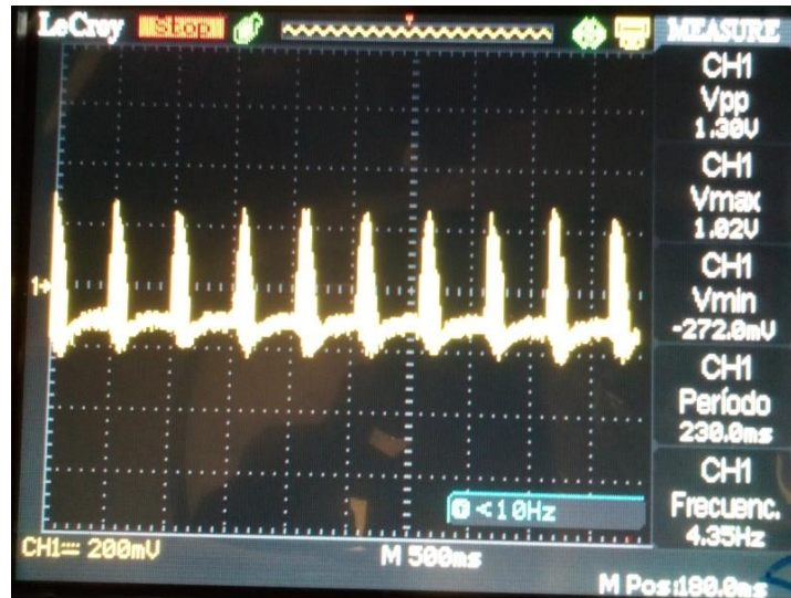
Figura 5.19: Respuesta de la señal del sensor de pulso en el osciloscopio.
