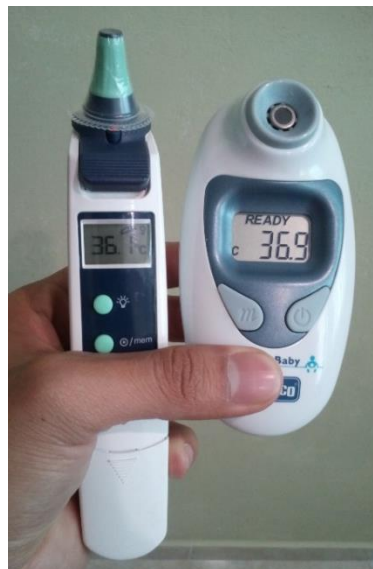
Figura 5.24: Temperatura obtenida con el termómetro para oído y con el termómetro para frente.
