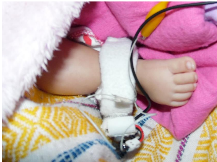
Figura 5.44: Colocación del dispositivo en el tobillo derecho del bebé.
