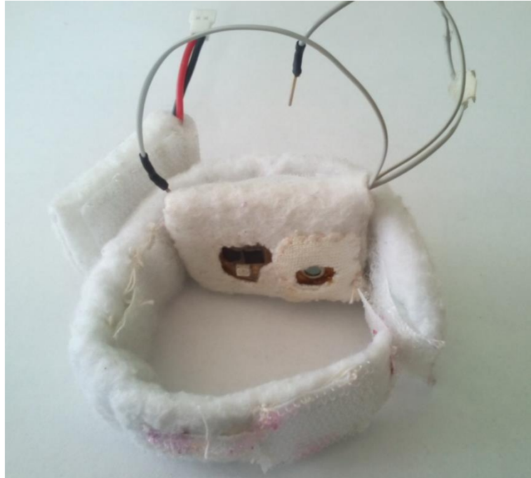
Figura 2.28: Prototipo final del dispositivo para monitoreo de pulso y temperatura en bebés.
