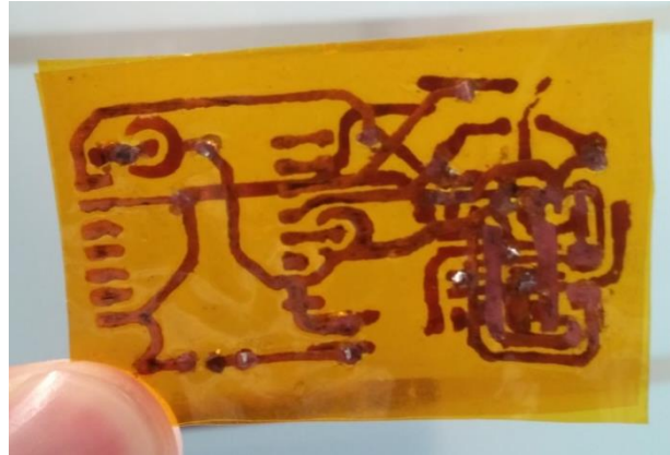
Figura 2.18: Unión de la capa superior e inferior del circuito flexible.
