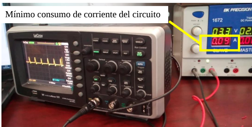
Figura 2.23: Consumo de corriente mínimo del dispositivo, visto desde la fuente de alimentación externa.
