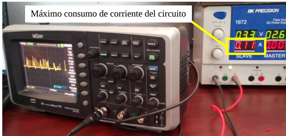
Figura 2.24: Consumo de corriente máximo del dispositivo, visto desde la fuente de alimentación externa.
