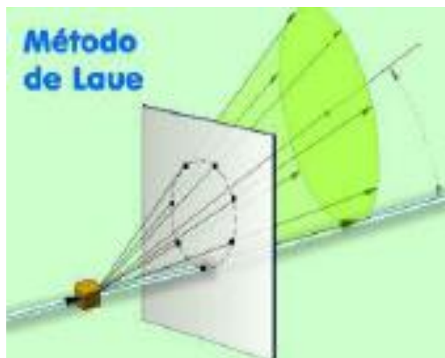
Figura 53. Esquema del método de Laue de transmisión, (66)
