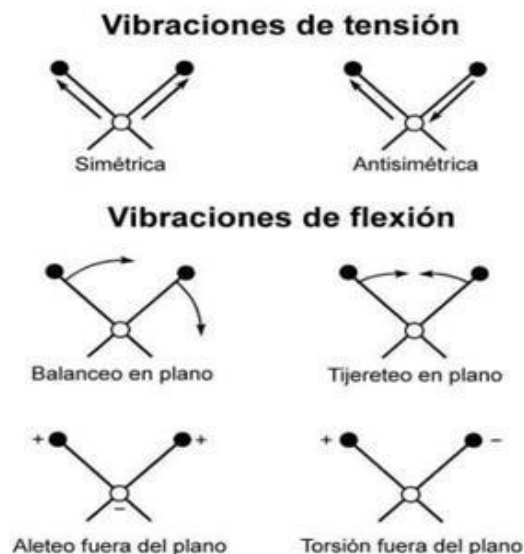
Figura 48. Tipos de vibraciones moleculares.
