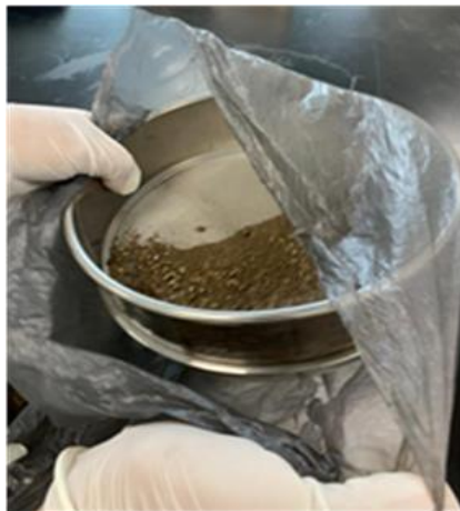
Figura 11. Tamizado de las muestras
