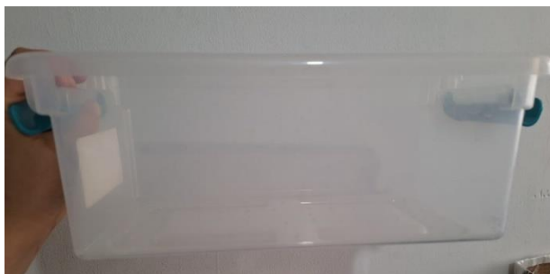
Figura 5. Caja plástica con medidas 35.9 cm x 19.4 cm x 12.4 cm y un volumen de 5.7 L. En la parte inferior de la caja ha sido perforada de manera que el flujo sea uniforme.
