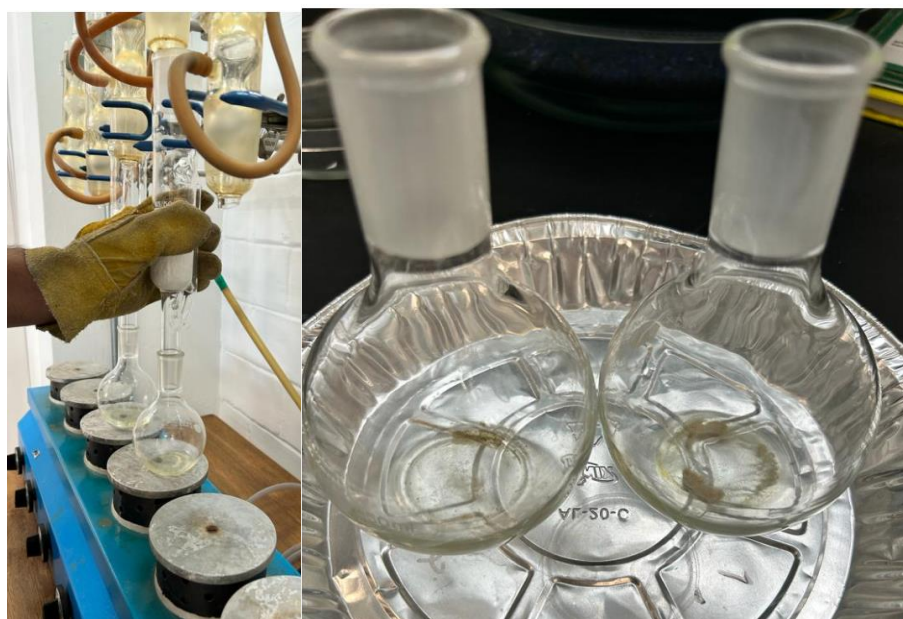
Figura 15. Proceso de recirculación para la extracción de grasas y aceites
