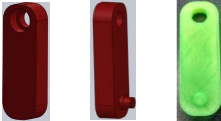
Figura 4.6 Barra de transmisión de movimiento
