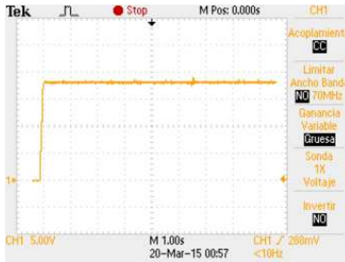
Figura 4.20 Respuesta de motor con motoreductor a entrada escalón
