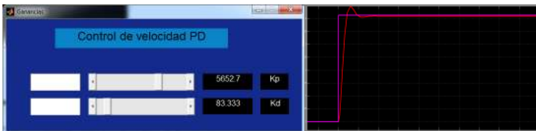
Figura 4.33 Prueba de respuesta del sistema
