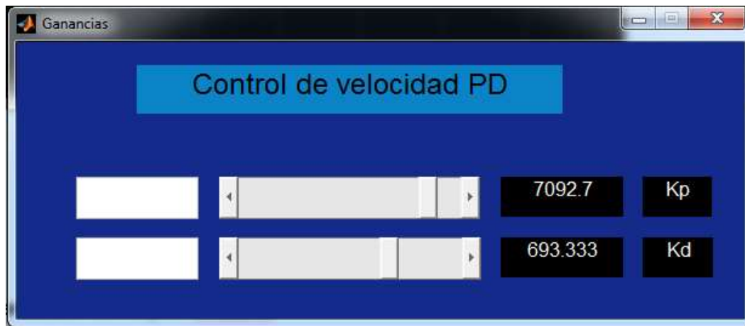
Figura 4.35 Valores de sintonización del control
