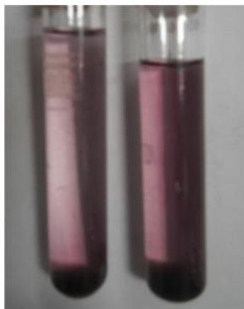
Figura 3.5. Crecimiento en el Caldo Tioglicolato de las muestras tomadas en la celda (Izquierda) y en los lodos del inóculo (Derecha)
