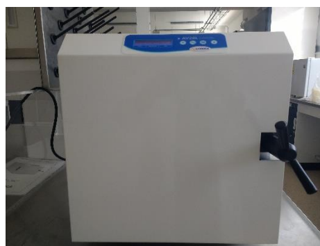
Figura 2.7. Esterilización de medios de cultivo en autoclave a 121°C por 15 min
