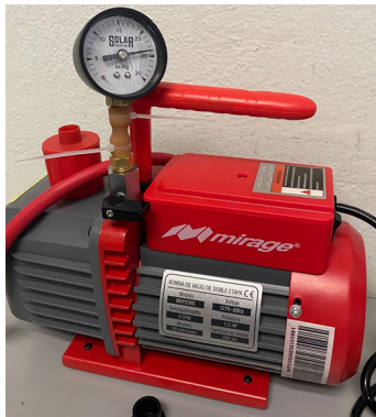
Figura 3.5: Capacidad de vacío de la bomba utilizada
