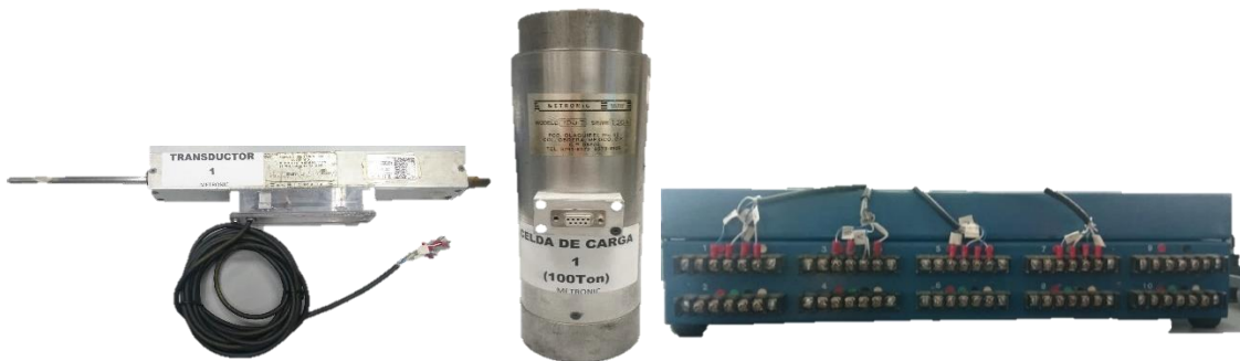
Figura 4-4 Sistema de adquisición de datos METRONIC, transductor, celda de carga y datalogger respectivamente de izquierda a derecha
