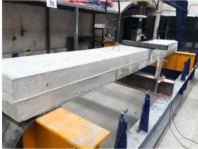
Figura 4-6 Set up, colocación de probeta y dispositivo de prueba en las losas
