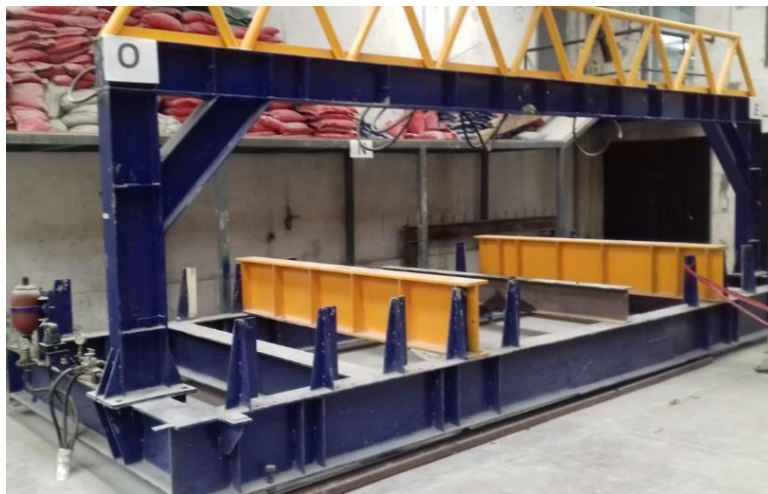
Figura 4-1 Marco de losas vista frontal
