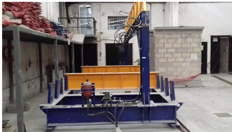
Figura 4-2 Marco de losas vista lateral
