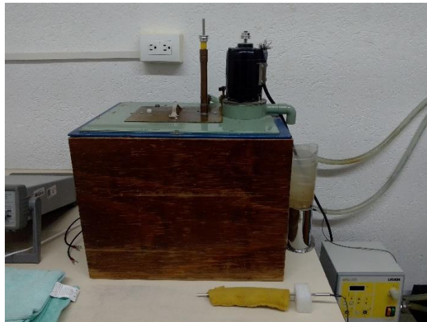
Figura 21. Calorímetro de combustión de bomba estática.
