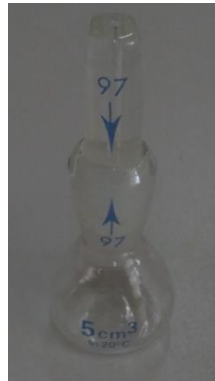
Figura 18. Picnómetro de 5 \text{ cm}^3 utilizado en este trabajo.
