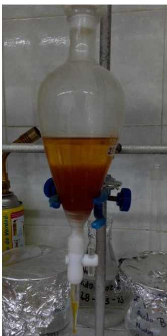
Figura 17. Embudo de separación con biodiésel y glicerol.
