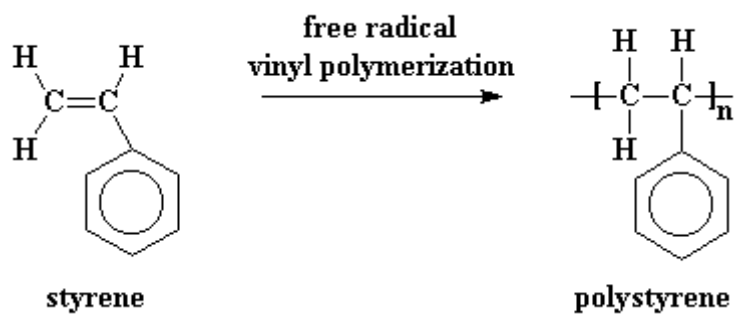
Figura 10. Modificación estructural del estireno por polimerización de radicales libres.
