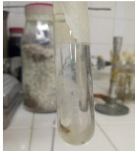
Figura 32. Crecimiento de micelio en el medio líquido Czapek con PS como fuente de carbono.
