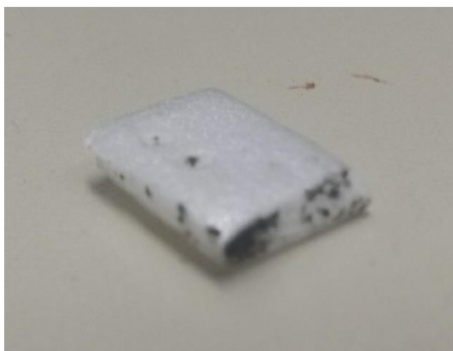
Figura 24. Poliestireno expandido con crecimiento de hongo en la superficie. El crecimiento de los hongos se localizó en las orillas del material, donde la superficie es más porosa.
