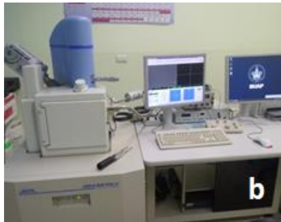
Figura 16. Equipos de observación y preparación de muestras para análisis SEM a) Equipo de recubrimiento de muestras no conductoras, b) Microscopio electrónico de barrido.
