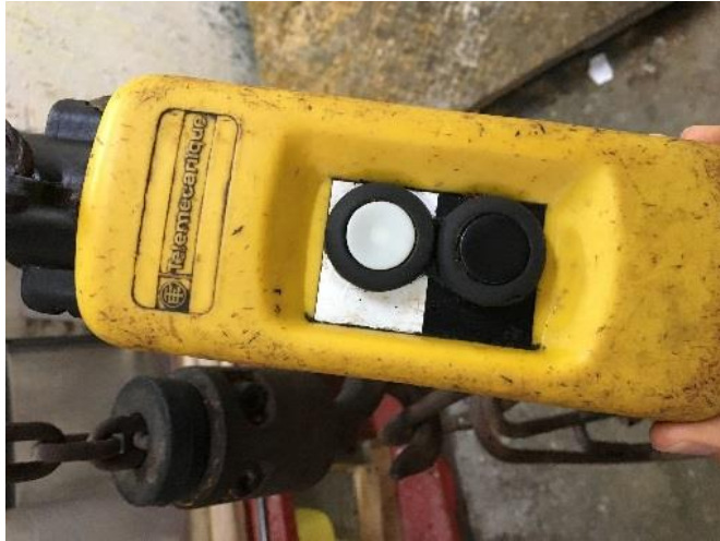
Ilustración 3. Control de Polipasto
