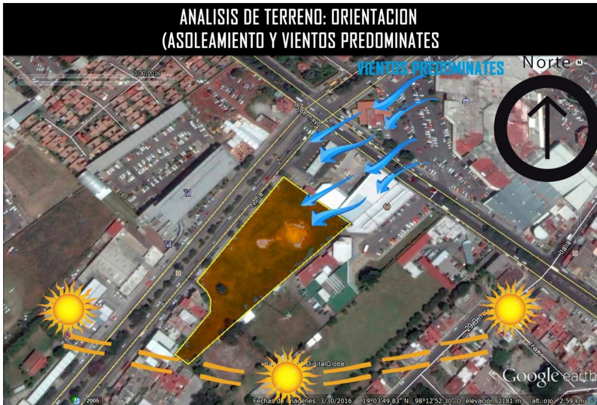
Fotografía 97 Asoleamiento y vientos dominantes sobre el predio
