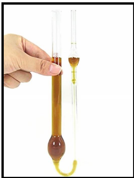
Figura 2.5 Viscosímetro de Ostwald utilizado en la determinación de la viscosidad cinemática del biodiesel.
