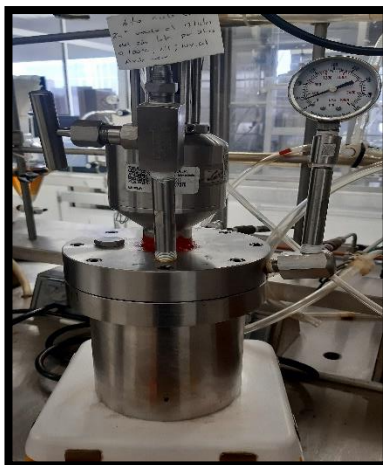
Figura 2.2 Reactor de acero inoxidable para la producción de biodiesel
