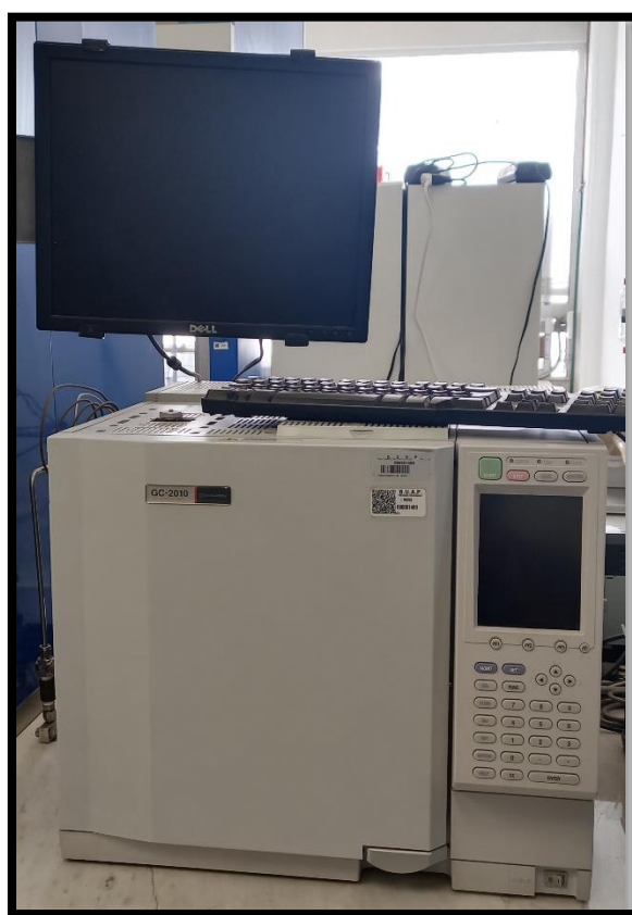
Figura 2.6 Cromatógrafo de gases GC 2010 utilizado en la determinación del Análisis de mono, di, triglicéridos residuales.
