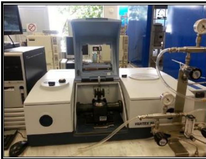
Figura 2.3 Espectrofotómetro de infrarrojo por transformada de Fourier FTIR.
