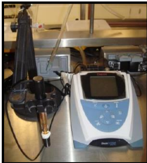
Figura 2.4 Potenciómetro utilizado en la determinación de las densidades específicas de sitios ácidos y básicos de los catalizadores.
