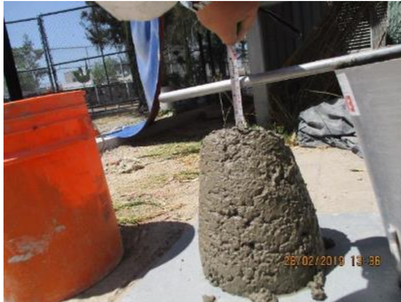
Figura 3-10 Toma del revenimiento del concreto
