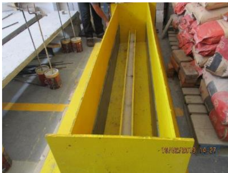
Figura 3-8 Ejemplo de habilitado de cimbra universal del laboratorio
