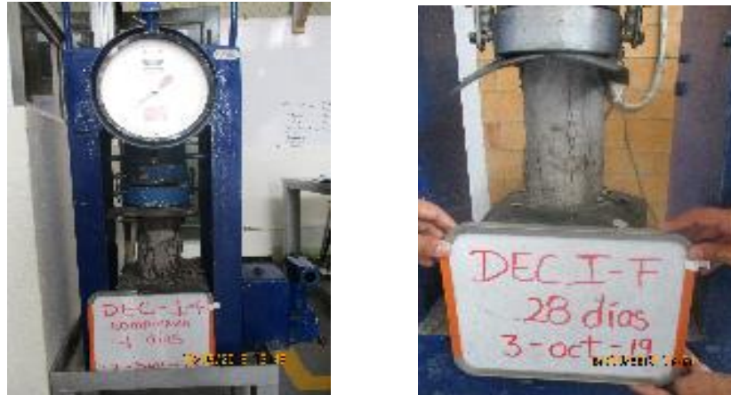
Figura 3-15 Ensayo de cilindros de concreto
