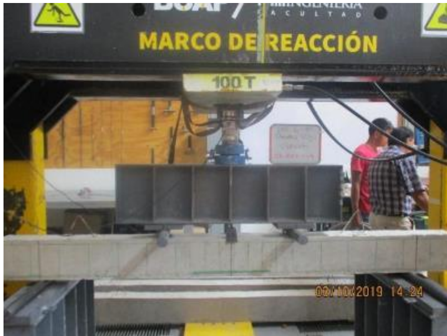
Figura 4-5 Colocación de VCT en el Marco de Reacción
