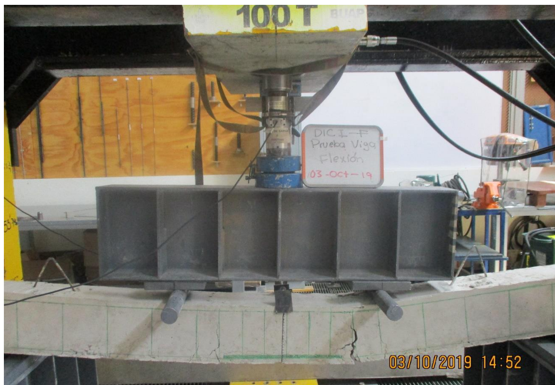
Figura 4-11 Estado de colapso de VCT
