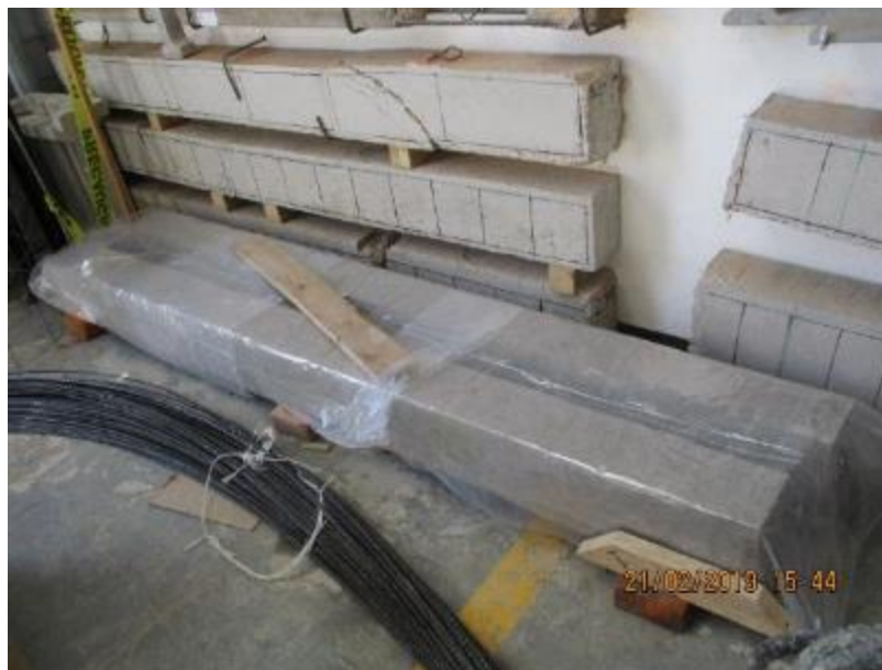
Figura 3-14 Curado de vigas en el laboratorio de estructuras
