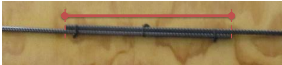
Figura 2-4 Traslape de acero longitudinal.
