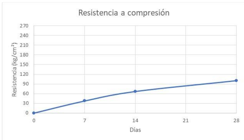
Figura 4-7 Resistencia del concreto empleado en VCT
