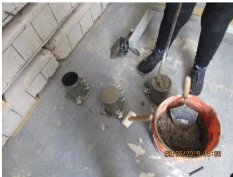
Figura 3-13 Muestreo del concreto en cilindros
