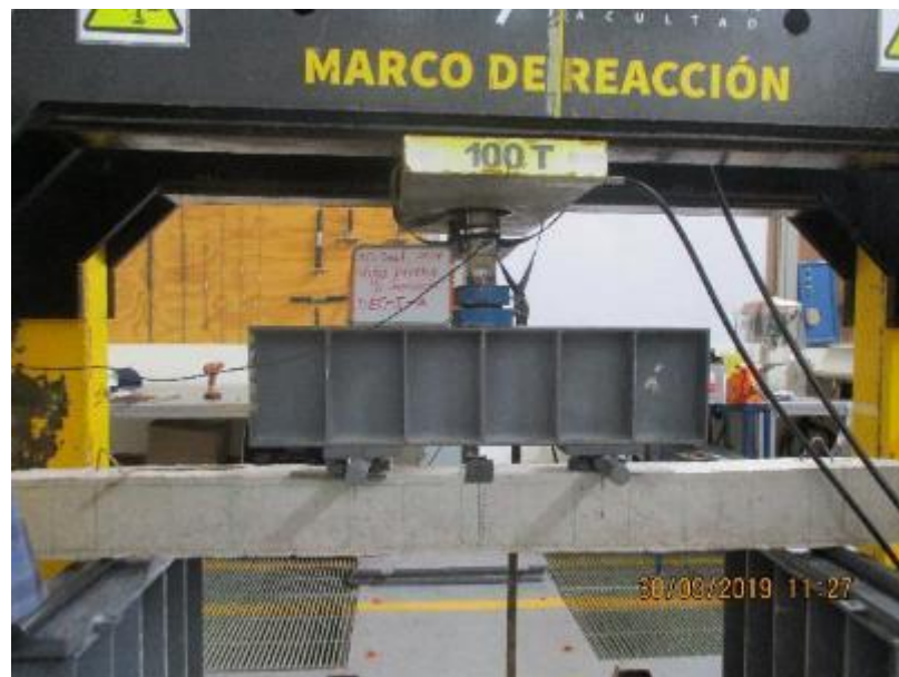
Figura 4-4 Colocación de VST en el Marco de Reacción
