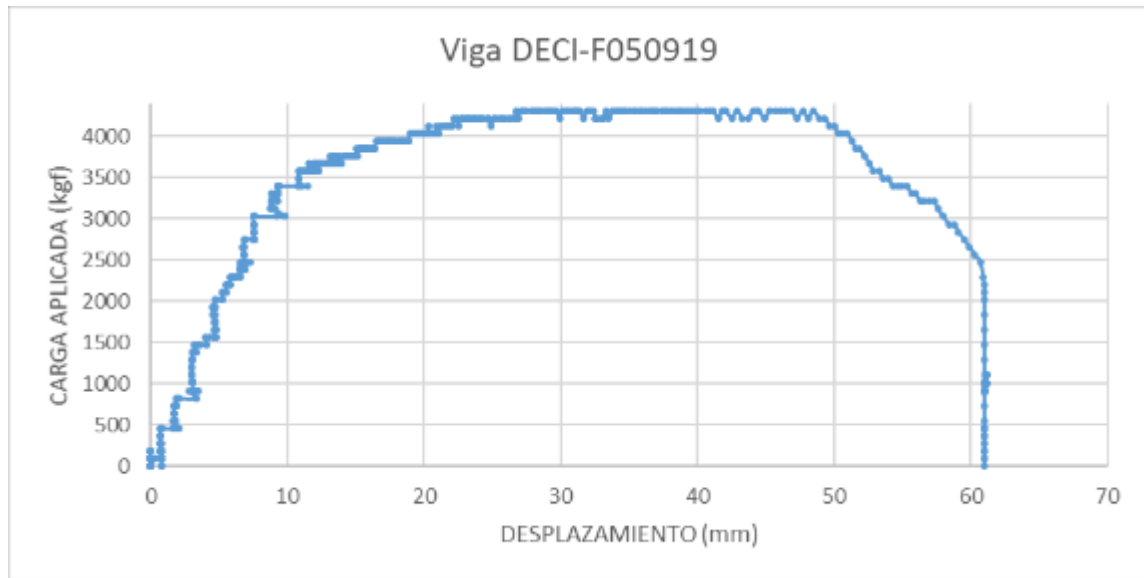
Figura 4-10 Relación Carga – Desplazamiento VCT
