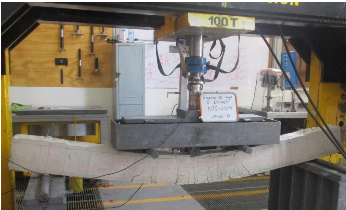
Figura 4-9 Estado de colapso de VST
