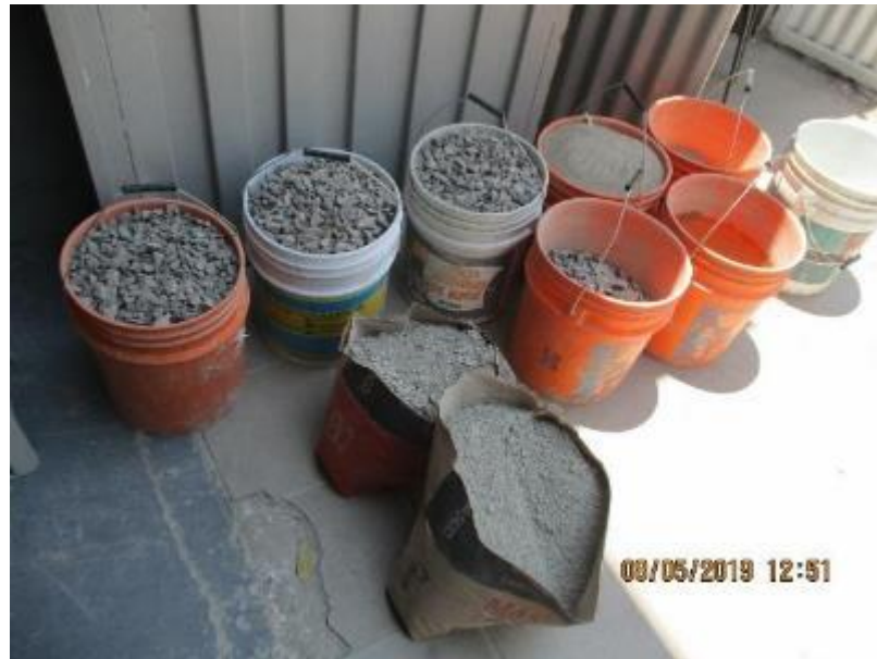
Figura 3-9 Materiales cuantificados para la fabricación de concreto
