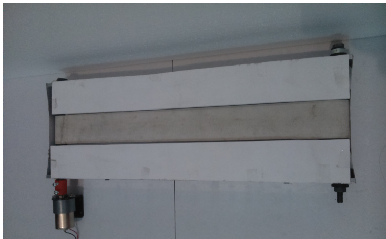
Figura 3.6: Prototipo final de banda transportadora
