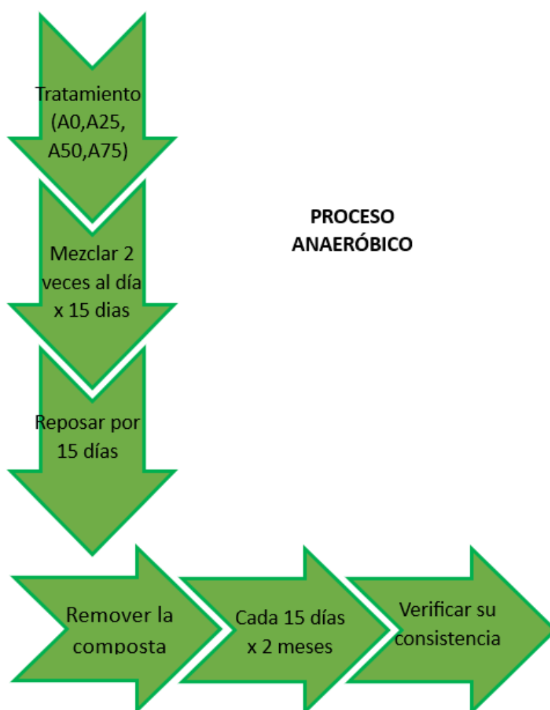
Figura 16 Proceso de fermentación para las muestras. Como resultado de este proceso se generan residuos con un alto grado de concentración de nutrientes y materia orgánica que pueden ser aplicados en fresco debido a que se eliminan los malos olores.
