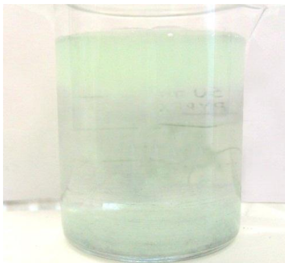
Figura 3.4 Suspensión de hidróxido de níquel generada después de la ejecución de la electrólisis.
