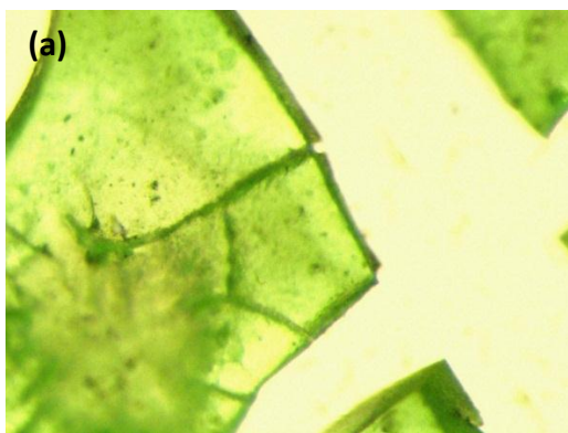
Figura 3.6 Microscopía óptica de cristales de \text{Ni(OH)}_2 obtenidos durante los experimentos 10 (a) y 15(b).
