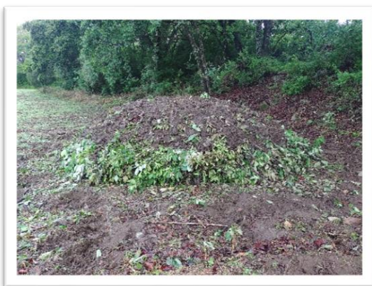
Fotografía de campo 13. Pre armado del horno que está por encenderse.
