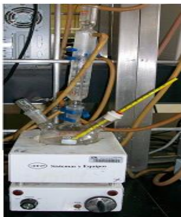
Figura 11. Esquema de síntesis del nanocatalizador \text{CuMn/TiO}_2 -3-6.
