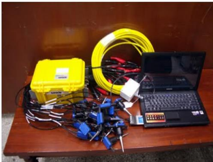
Figura 24. Equipo Geode de la marca Geometrics con sus herramientas. Fuente: Ulloa (2008).
