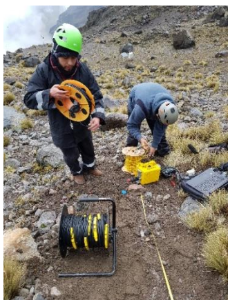
Figura 87. Preparación del tendido sísmico en la zona de till subglacial. Fuente: fotografía tomada por Morales, M. (2019).
