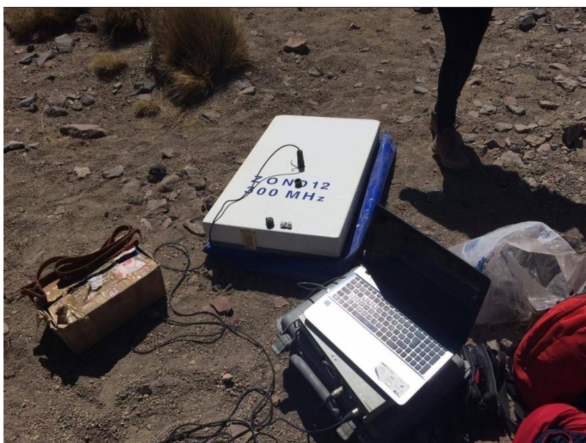
Figura 22. Equipo Zond 12e 300 Mhz, utilizado para la adquisición de datos GPR. Fuente: Propia.
