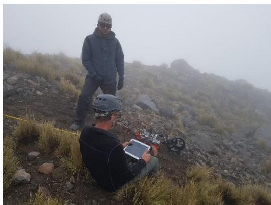
Figura 89. Configurando parámetros de adquisición con el GPR GSSI 350 Mhz. Fuente: fotografía tomada por Morales, M. (2019).
