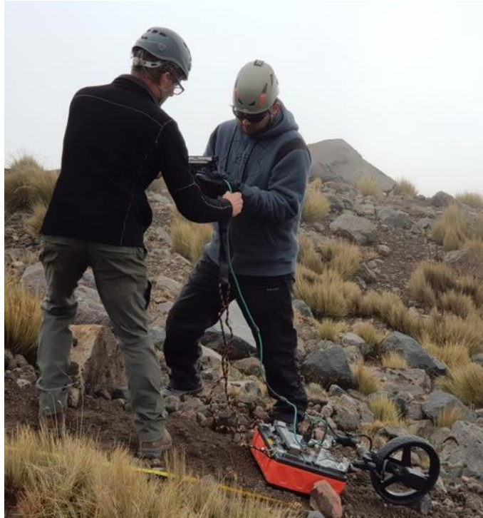
Figura 23. Equipo GSSI Utility Scan 350HS, utilizado para la adquisición de datos GPR. Fuente: Fotografía tomada por Sieron K.
