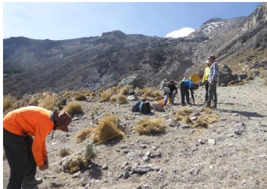
Figura 82. Realización de sísmica de refracción en la zona albergue. Fuente: fotografía tomada por Sieron, K. (2019).
