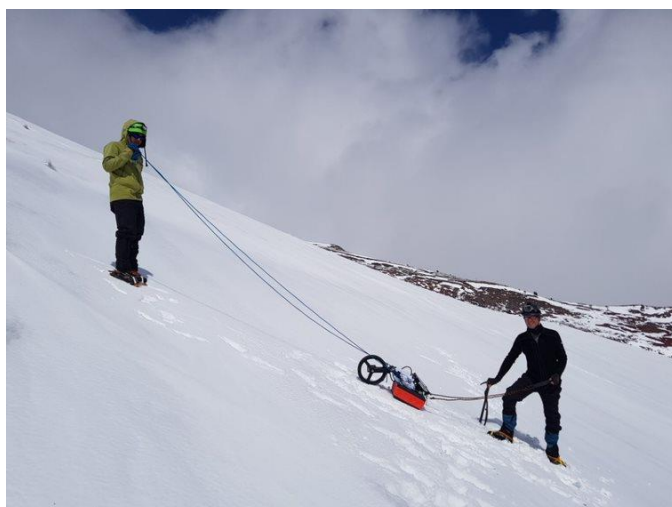
Figura 92. Adquisición de perfil GPR realizados por el Dr. Weissling en 2019 sobre el glaciar Jamapa. Fuente: fotografía tomada por Morales, M. (2019).
