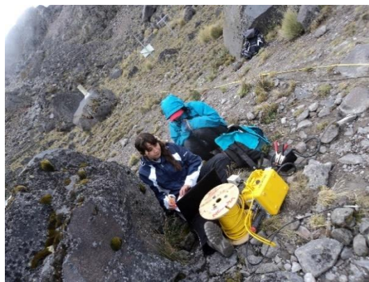
Figura 86. Adquisición de datos de sísmica de refracción. Fuente: fotografía tomada por Morales, M. (2019).
