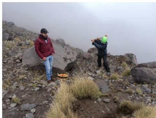
Figura 86. Adquisición de datos de sísmica de refracción. Fuente: fotografía tomada por Morales, M. (2019).
