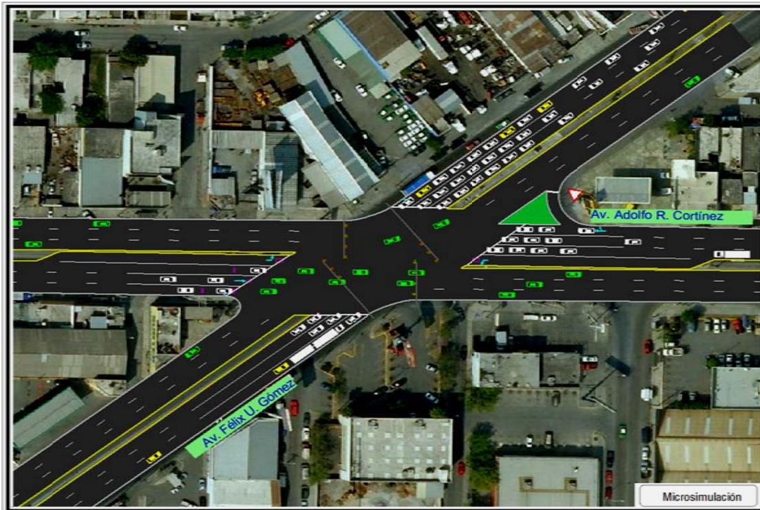
Figura Núm. 5.17 Esquema de Operación de la Propuesta de Solución, para la Intersección de la Av. Félix U. Gómez con Av. Adolfo Ruíz Cortínez.
