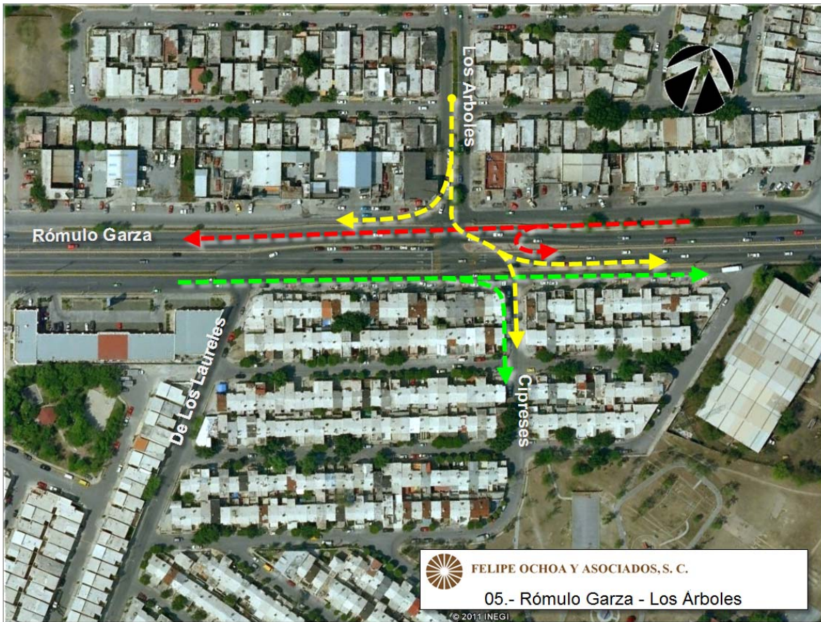
Figura Núm. 5.7 Nuevos Movimientos Direccionales para la Intersección de Av. Los Árboles con la Av. Rómulo Garza. Propuesta de Solución - Par Vial: Los Árboles - Las Flores. (Fuente: Google Earth., 2012)
