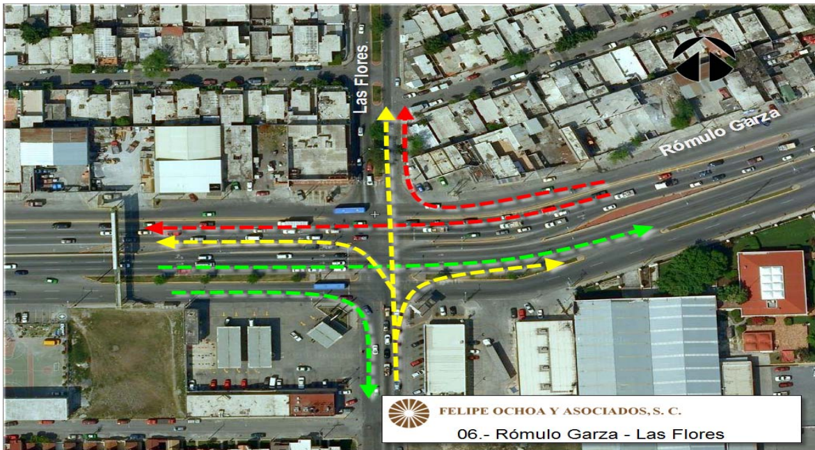
Figura Núm. 5.8 Nuevos Movimientos Direccionales para la Intersección de Av. Las Flores con la Av. Rómulo Garza. (Fuente: Google Earth., 2012)
