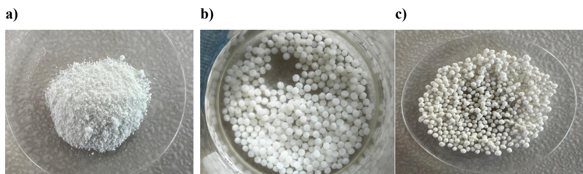
Figura 2. Aspecto de los adsorbentes: a) polímero prístino EGAN80, b) perlas hinchadas y c) perlas secas.
