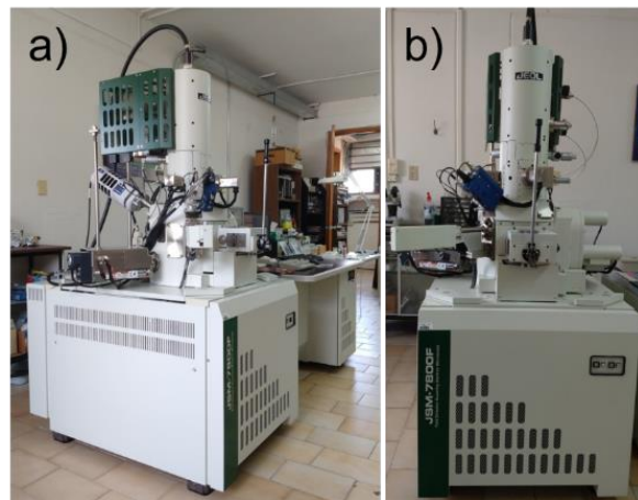
Figura 16. Microscopio Electrónico de Barrido de emisión por campo ( Jeol , JSM-7800F ) Vista a) \frac{3}{4} y b) frontal. Laboratorio de análisis de superficies, IFUAP.
