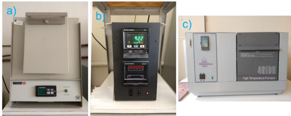
Figura 11. Muflas utilizadas en el proceso de síntesis. Calcinación en la mufla a) Sola Basic modelo Lindberg con b) programador Eurotherm y el Sinterizado en la mufla c) Thermolyne modelo 46100. Laboratorio de Crecimiento de Materiales Ferroicos, IFUAP.
