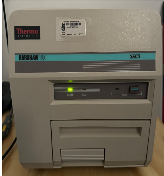
Figura 5.2: Equipo de lectura HARSHAW 3500 para medir la respuesta termoluminiscente de los dosímetros TLD-100.
