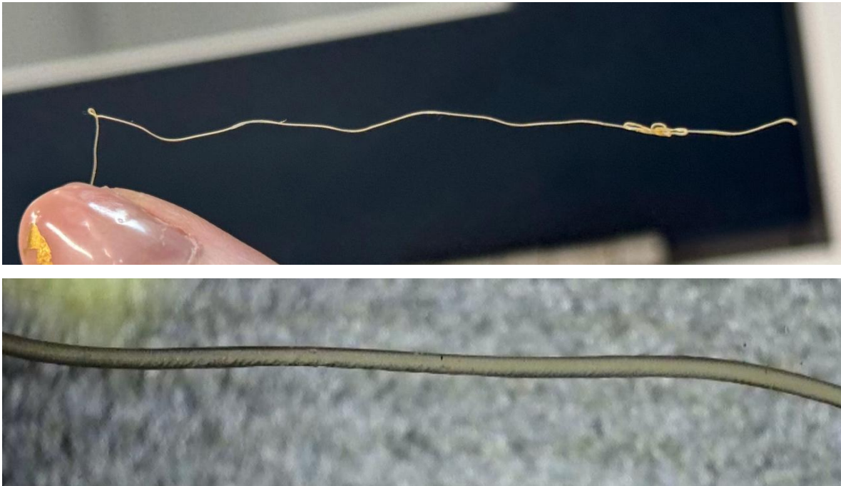
Figura 19. Apariencia de una fibra de CS precipitada en solución \text{NH}_4\text{OH} con \text{H}_2\text{O}:\text{EtOH} en disolvente (superior). Apariencia de la misma fibra en microscopio digital (inferior)
