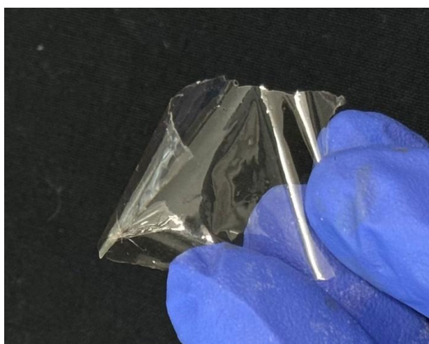
Figura 28. Apariencia de película monocapa de 20% PLA
