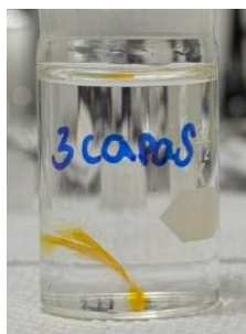
Figura 9. Imagen de una película tricapa de 5% PLA con CSHMw-derivado de acrilonitrilo en agua destilada para la medición de la liberación del dye.
