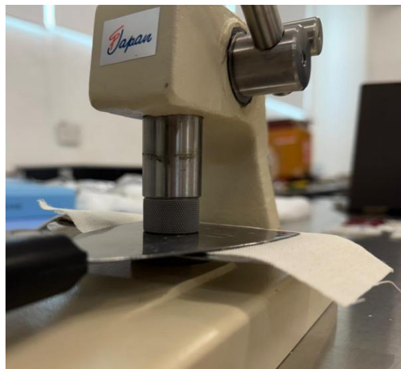
Figura 11. Imagen del arreglo experimental con el que se adhirieron las películas al textil.
