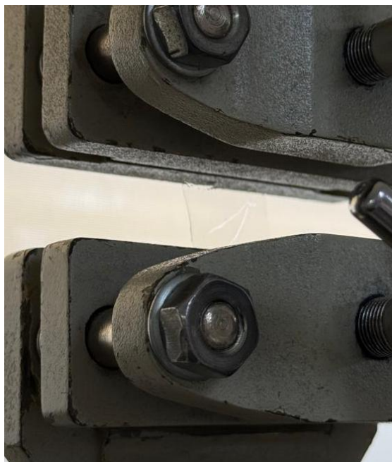
Figura 8. Imagen de una película tricapa de 5% PLA con 5% de CS entre mordazas de dinamómetro
