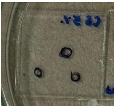
Figura 24. Película de CS al 5% en HAc al 2%, obtenida mediante el método de spin coating
