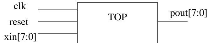
Figura 3.2. Entradas y salidas del PRNG a implementar en VerilogA.
