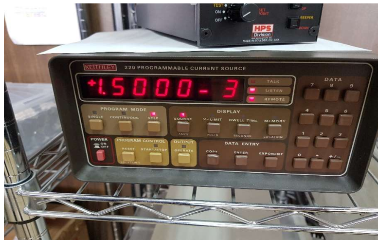
Figura 7. Fuente de corriente programable. Este instrumento cuenta con un rango de 0 a 10mA con una precisión del 0.05%.
