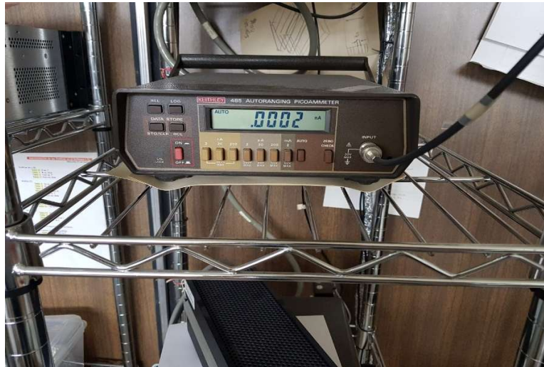
Figura 8. Picoamperímetro digital de marca Keithley modelo 485. Este equipo es utilizado para medir que la corriente se mantenga constante. Tiene una resolución de 100nA.
