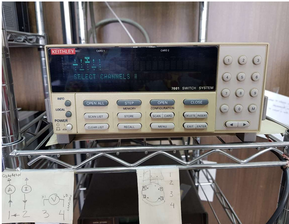
Figura 10. Conmutador digital. Este conmutador nos ayuda a seleccionar las diferentes configuraciones por la técnica de cuatro puntas.
