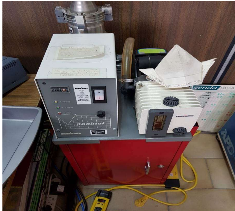
Figura 12. Equipo de vacío. A la izquierda se observa la bomba de arrastre molecular. A la derecha, la bomba mecánica. Éstas están conectadas en serie.
