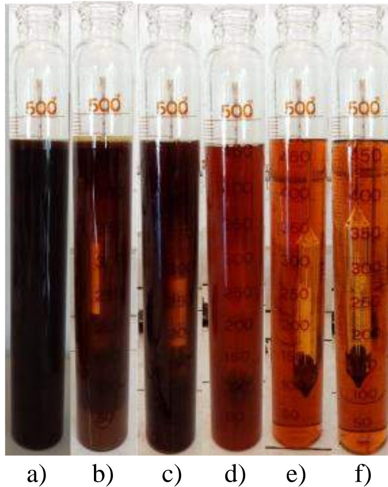
Figura 3.17 Muestras de vinaza diluidas al 50% a) vinaza original, b) vinaza alcalinizada a 23°C, c) vinaza acidificada a 23°C, d) vinaza con 0.1% de carbón activada, e) vinaza con 0.25% de carbón activado, f) vinaza con 0.5% de carbón activado
