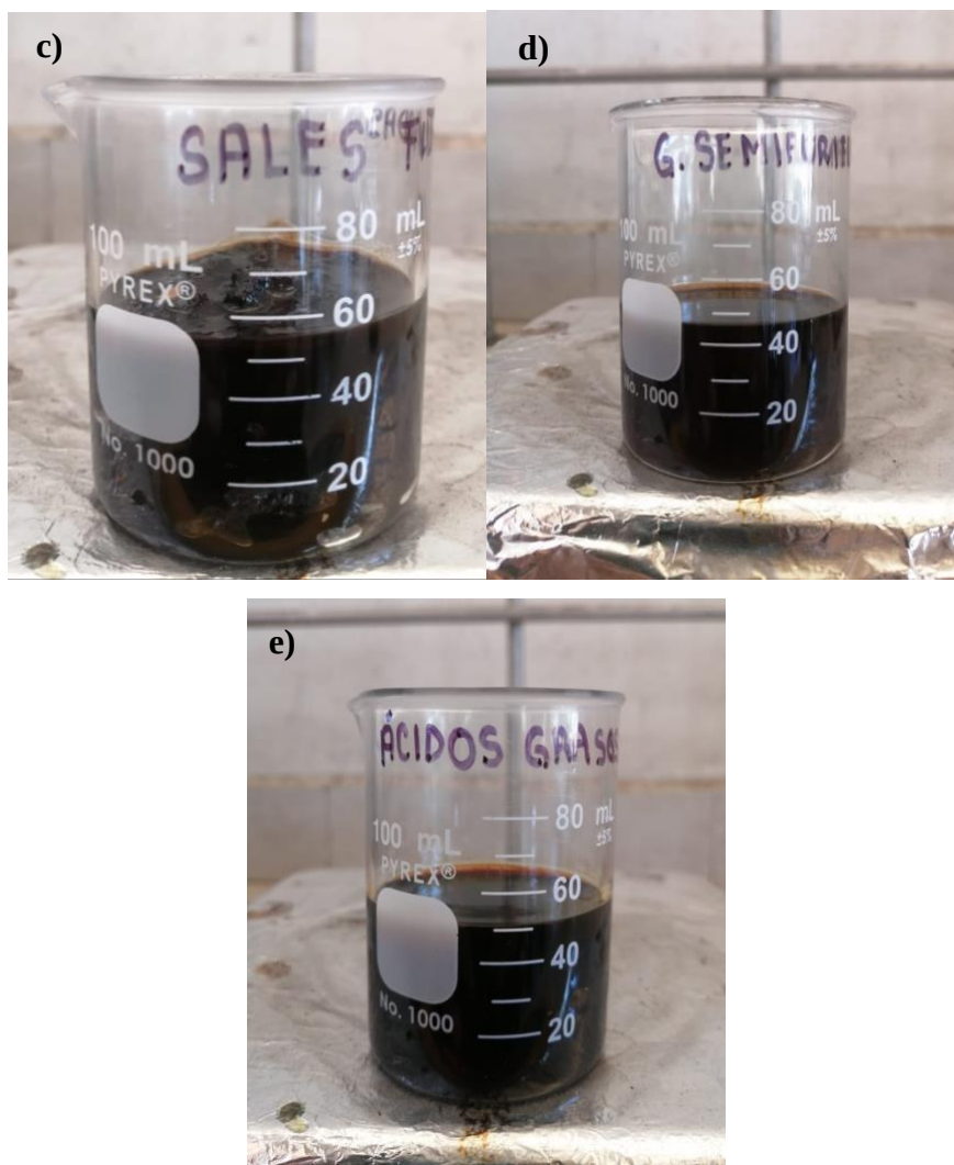
Figura 3.3. a) Glicerina Cruda, b) Glicerina Acidificada, c) Sales Filtradas, d) Glicerina Semipurificada y e) Ácidos Grasos.
