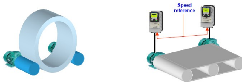
Figura 2.12: Sistema colaborativo de motores[32]
