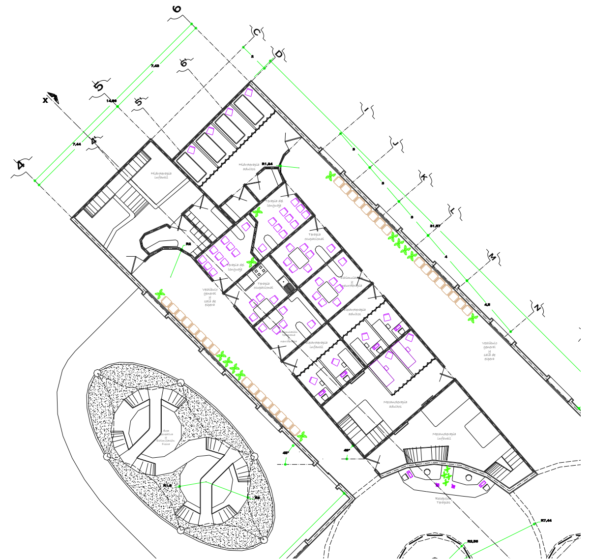
Imagen 60. Planta Arquitectónica Zona de Rehabilitación
