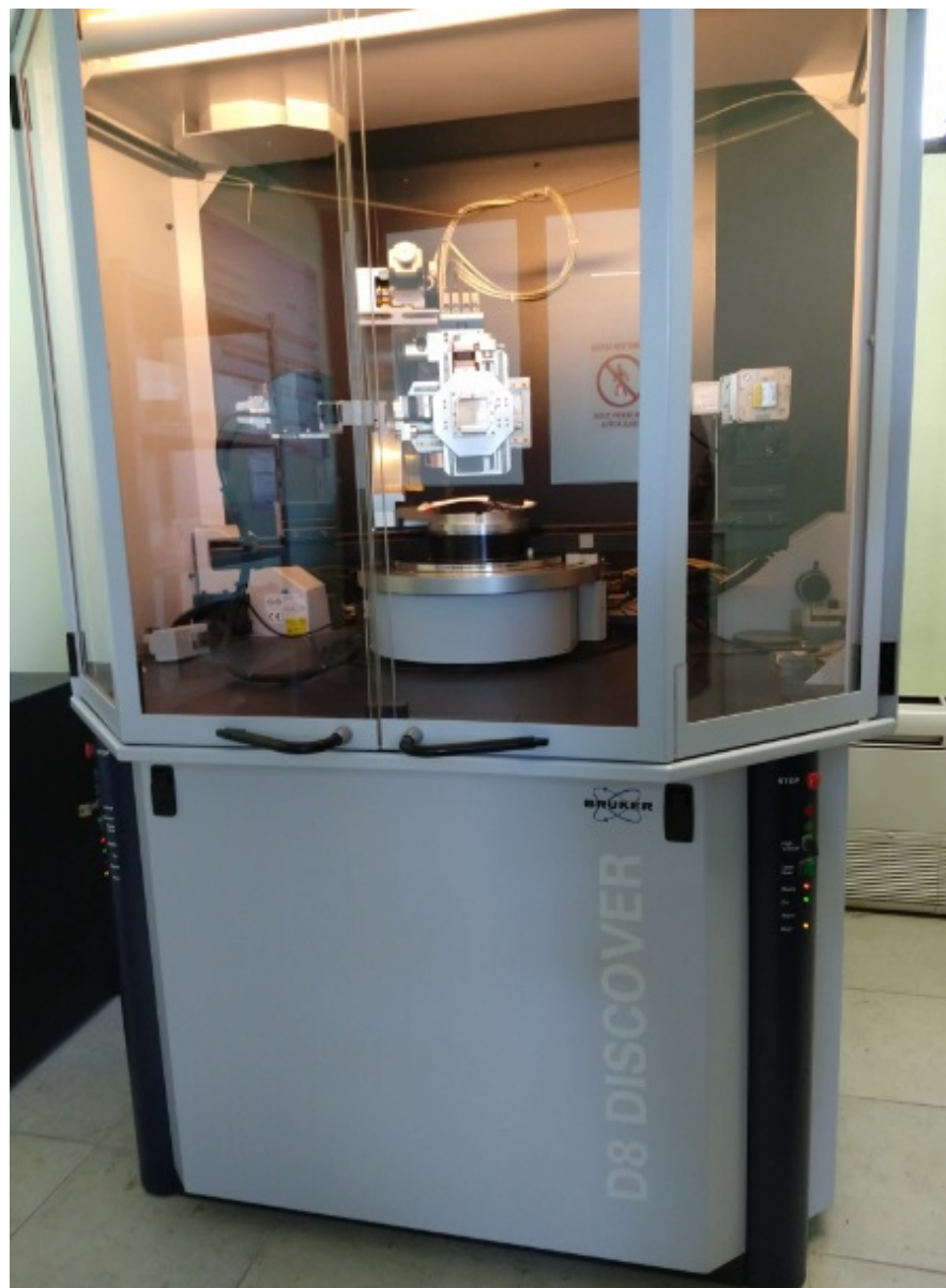
Figura 3.3: Difractómetro de rayos X BRUKER Discover D8 que se usó para obtener los difractogramas de las muestras de Gd_2O_3:Er^{3+} .
