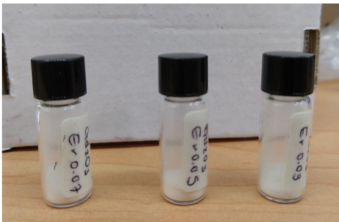
Figura 4.4: Muestras en polvo de Óxido de Gadolinio con incorporación de iones de Erblio al 0.07 mol %, 0.05 mol % y al 0.03 mol %.
