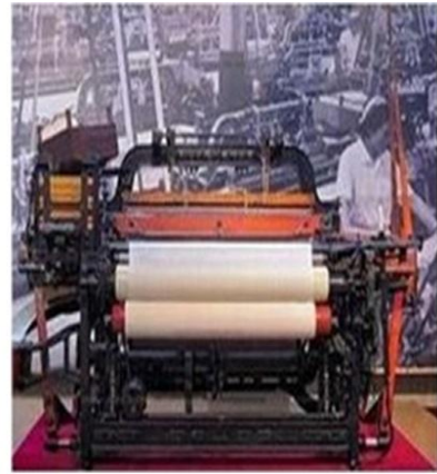
Telar automático modelo G, 1924
