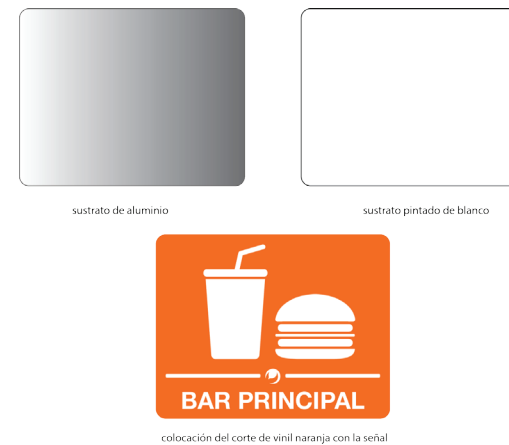
Figura 102. Forma de colocación de las señales.
