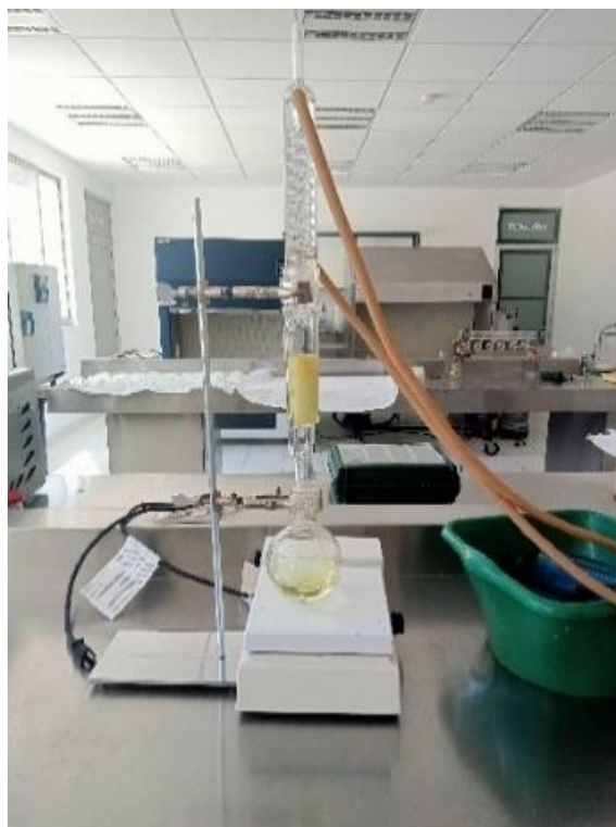
Figura 6. Extracción de Compuestos activos mediante método Soxhlet, para lo cual fueron necesarios 8 ciclos de “sifoneo”
