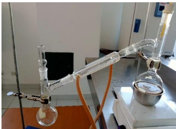
Figura 7. Destilación simple. Este método se ajustó a la temperatura de ebullición de cada disolvente y con ello se obtuvo cada extracto alcohólico.
