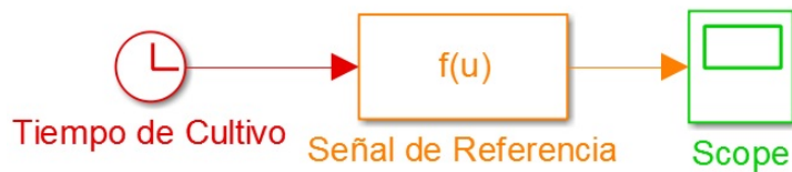
Figura 3.10: Diagrama a bloques para obtener la señal de referencia en Simulink.
