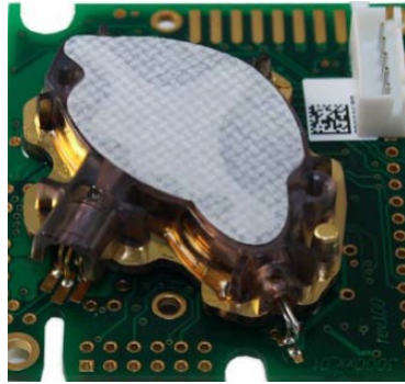
Figura 5.2: Sensor de CO 2 K-30.
