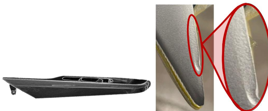
Figura 16. Botoneras con presencia del defecto escurrimiento de barniz.
