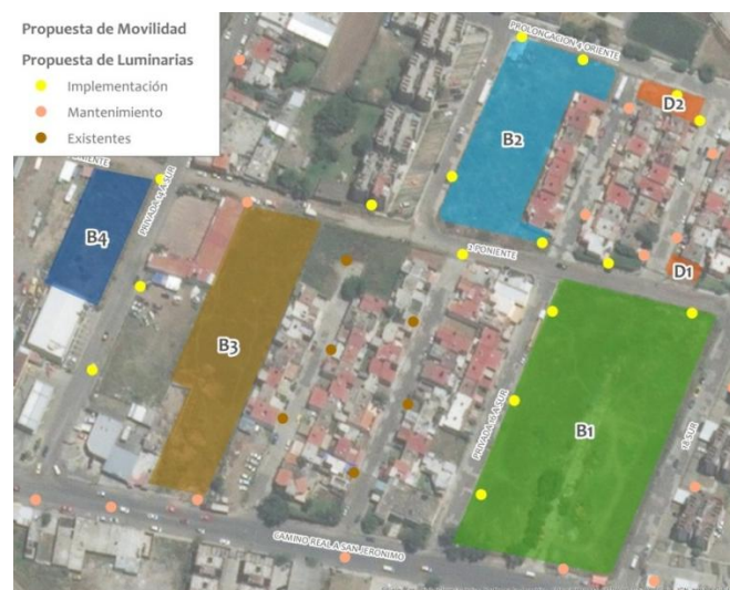
Fig. 3.28 Ubicación y mantenimiento de postes para alumbrado público
