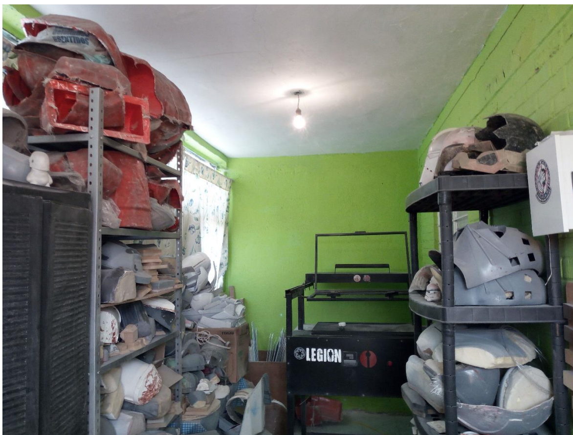
Figura 9. Taller de Alfonso en Ciudad de México. Al fondo es posible ver la pancha de termoformado, mientras que en los anaqueles se aprecian los moldes de distintos materiales para diversas partes de trajes.
