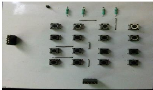
Figura 5.33 Tarjeta del módulo teclado Matricial
