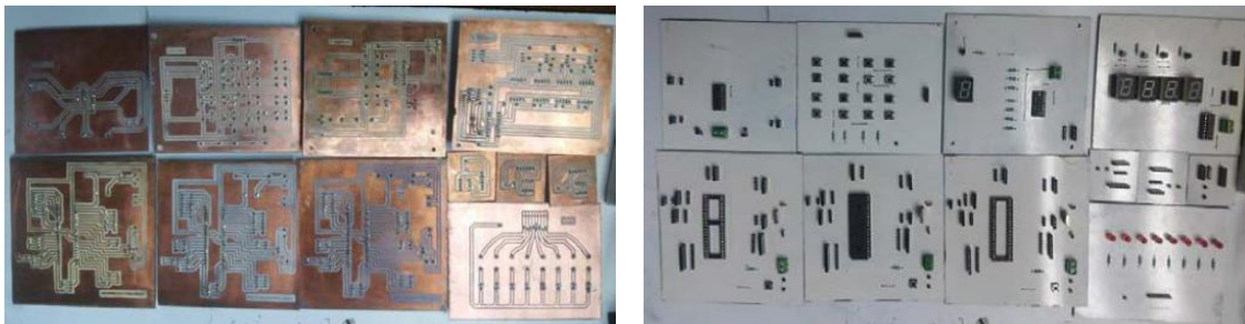
Figura 5.9 Grabado, montaje y soldado de todas las tarjetas.
