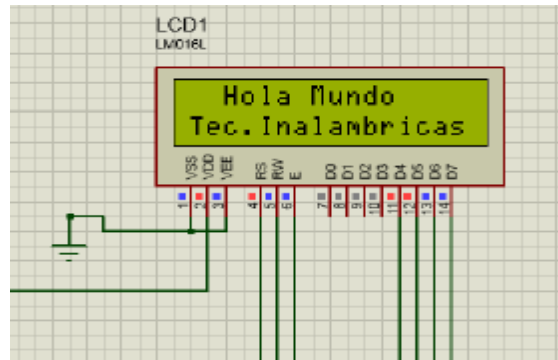
Figura 5.23 Simulación del Módulo LCD con Proteus.
