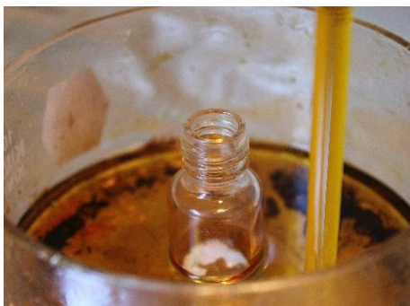
Figura 9. Anhídrido ftálico en tratamiento térmico
