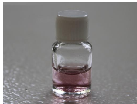
Figura 26. AuNPs obtenidas en relación 5:1 a) espectro UV-Vis b) color obtenido
