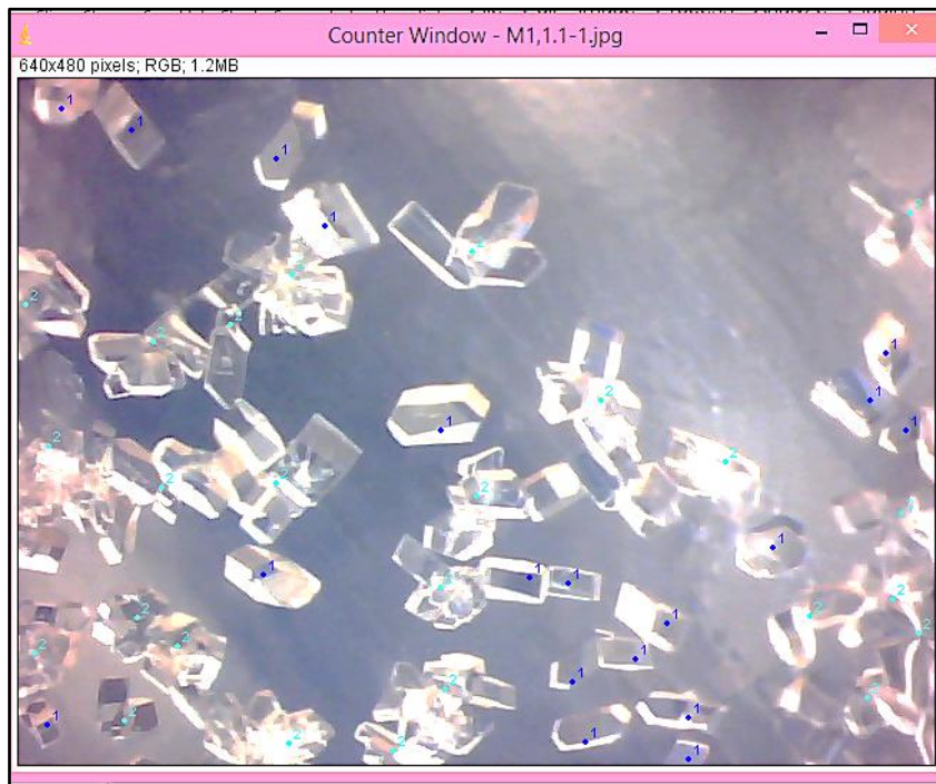
Figura 2. 12 Ejemplo de la imagen procesada para determinar las diferentes formas y tamaños presentes en las muestras.
