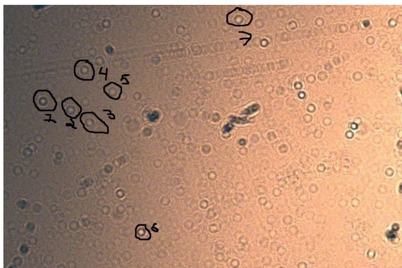
Figura 6.2: Patrones de difracción de microesferas de dióxido de silicio
