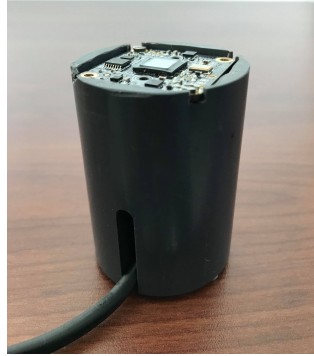
Figura 2.17: Primer tubo el cual sostiene al detector CMOS
