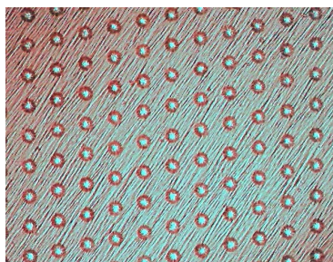
Figura 3.2: Pantalla celular vista con microscopio sin lentes
