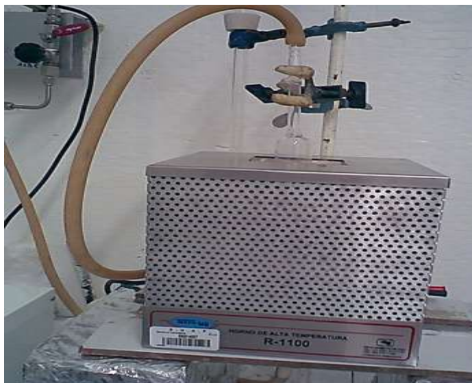
Figura 9. Calcinación con el Horno de Alta Temperatura, flujo de aire y controlador
