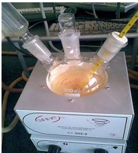
Figura 6. Representación del equipo de síntesis de los nanocatalizadores obtenidos.
