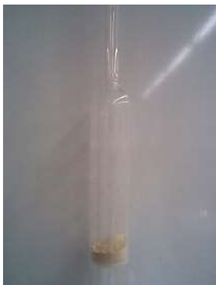
Figura 8. Reactor de cuarzo conteniendo cada nanocatalizador
