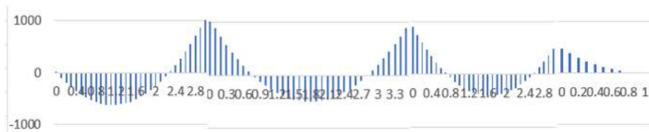
Figura 19.0. Diagrama de momentos del modelo estructural.
