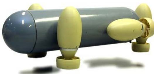
Figura 6: Mini-submarino Serafina. Este prototipo cuenta con un sonar el cual se encuentra en la parte delantera y puede llevar a cabo labores de salvamento y búsqueda de embarcaciones hundidas [14].
