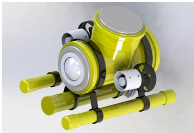
Figura 47: Estructura completa del submarino renderizado.
