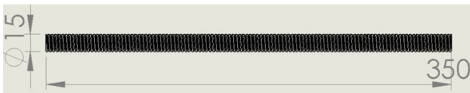
Figura 40: Tornillo sin fin prototipo 1, las cuales se encuentran en milímetros.
