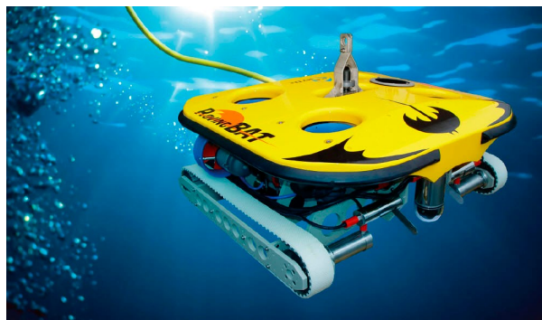
Figura 2: Mini-submarino tipo ROV conocido como Roving Bat es un prototipo multi-propósitos híbrido encargado de realizar tareas de inspección y limpieza [6].
