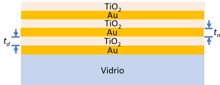
Figura 5.1: Esquema de un HMM que consiste en películas alternadas de Au y \text{TiO}_2 depositadas sobre un sustrato de vidrio.
