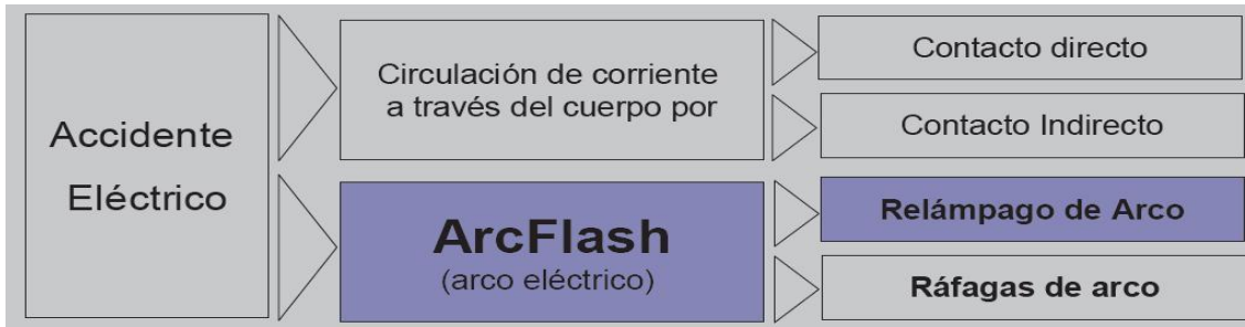
Figura 2.1 Tipos de Accidente Eléctrico, Origen, Estudio de Arc Flash.
