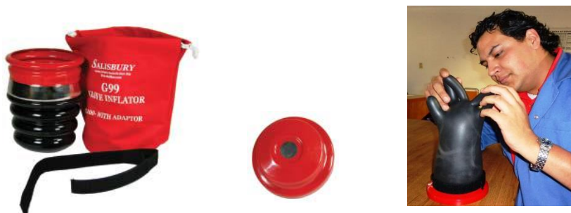
Figura 6.13 Equipo de Inspección de Guantes Aislantes de Caucho. Origen: Propio.
