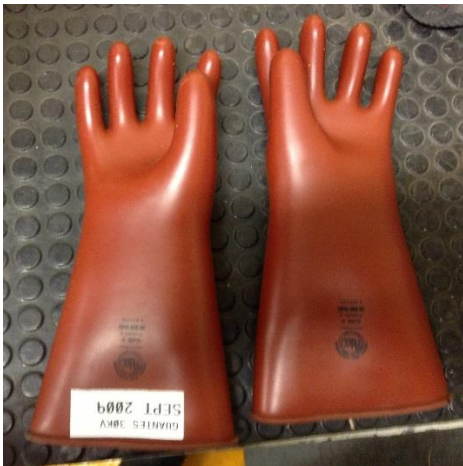
Figura 6.12 Guantes Aislantes de Caucho Nivel 4. Origen Propio.
