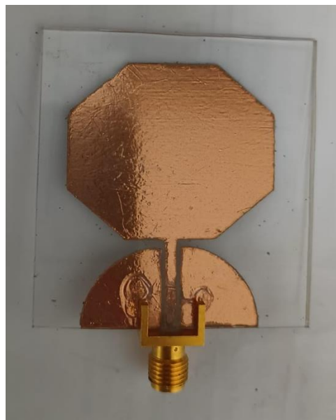
Ilustración 3.14. Antena elemental de cinta de cobre terminada.
