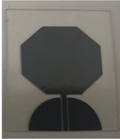
Ilustración 3.13. Antena elemental de cobre después del proceso del ácido férrico.
