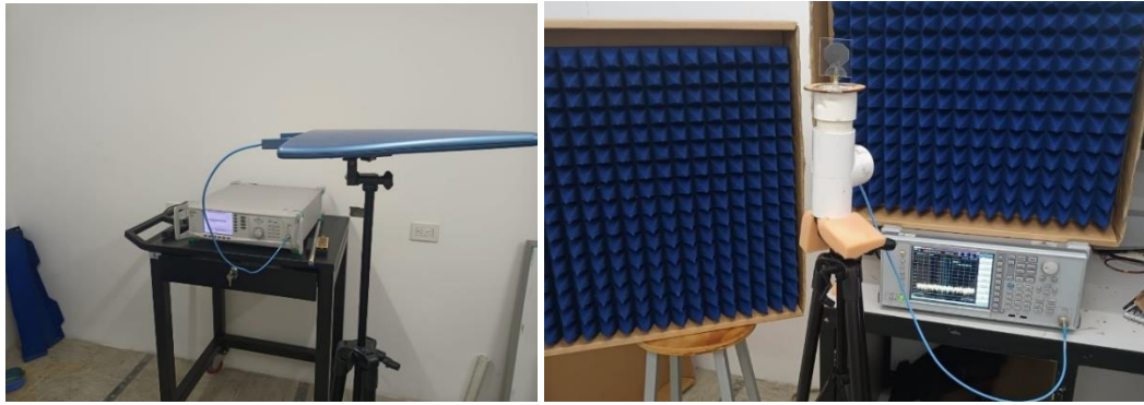
Ilustración 4.18. Medición de la ganancia en el Laboratorio De Caracterización En Sistemas Basados En Microondas FCE.
