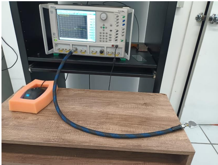
Ilustración 4.11. Medición del coeficiente de reflexión S_{11} en el Laboratorio De Caracterización En Sistemas Basados En Microondas FCE.
